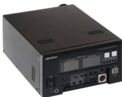
LS-750 シリーズ用ベースステーション。4K ライブにも余裕で対応可能な 3G-SDI 出力5系統、リターン、タリー、インターカム、ゲンロック、カメラリモート端子を装備し、カメラアダプターへの電源供給時でも、最長 2km のケーブル延長が可能です。
