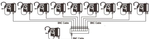
主な特長 ●有線式インターカム (片耳密閉型ヘッドセット) ●BNC ケーブルによる簡単接続 ●最長 2km まで最大 10 台接続可能 ●全員同時通話 ●単三乾電池 2 本で 200 時間以上通話可能
